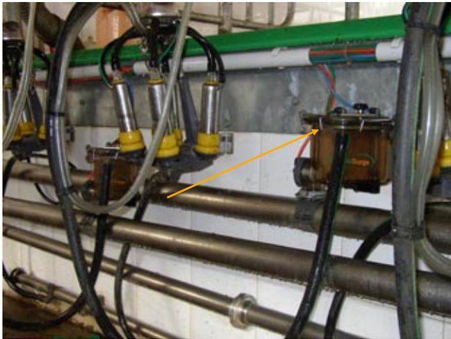
El vacío llega correctamente desde la válvula de lavado
