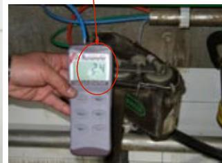
No llega vacío que levante la membrana del medidor.
