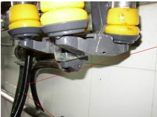
Esta conexión manda vacío a la válvula de lavado
